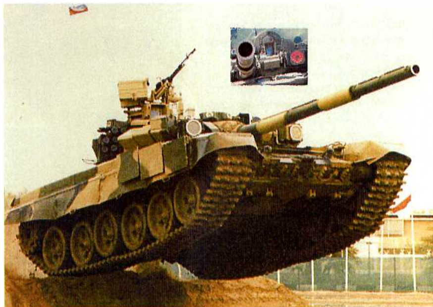
Russischer KPz T-90 ausgerüstet mit Softkill-APS Shtora-1
