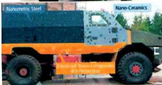
Multi Purpose Vehicle (MPV) 4x4 von IVECO/KMW mit modular aufgebauten passiven Schutzkomponenten der 4. Generation von IBD
