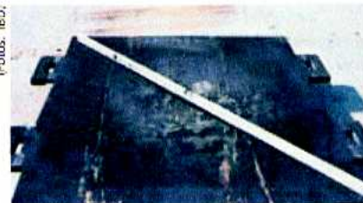
Zugbeanspruchung einer Platte durch Blast
